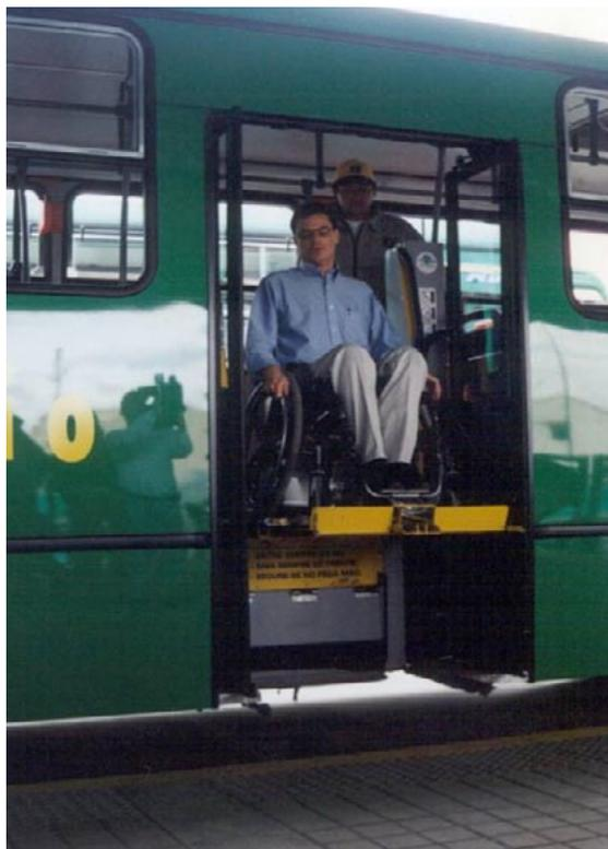
(Figura 13.78). Ainda que esse dispositivo não facilite a entrada de cadeiras de roda, ele torna o embarque algo mais fácil para idosos e outros que tem dificuldades com degraus.
